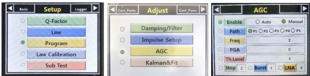
Figure 30 : 초음파 변환기의 수신 파형 증폭도 조정을 위한 AGC 메뉴
