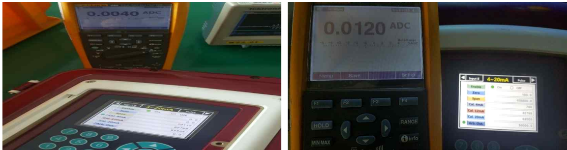
Figure 18 : 멀티미터를 이용한 4~20mA Calibration
